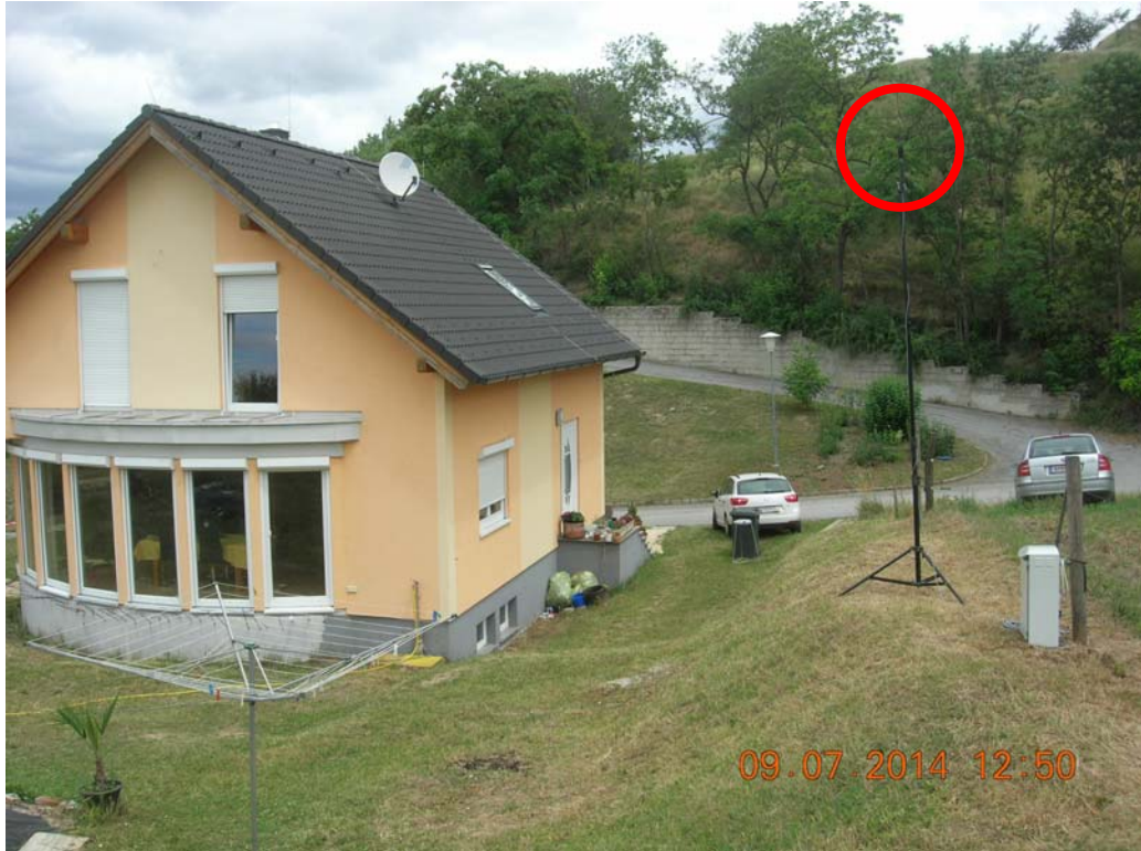
Abb. 17: Meßpunkt MP 09 – KG.Stronegg; Meßzeitraum 09 – 10.07.2014; Koordinaten: [GK.M34 Rw/Hw] -1440,1 / 388386,5 Meßgerät: Norsonic 140
