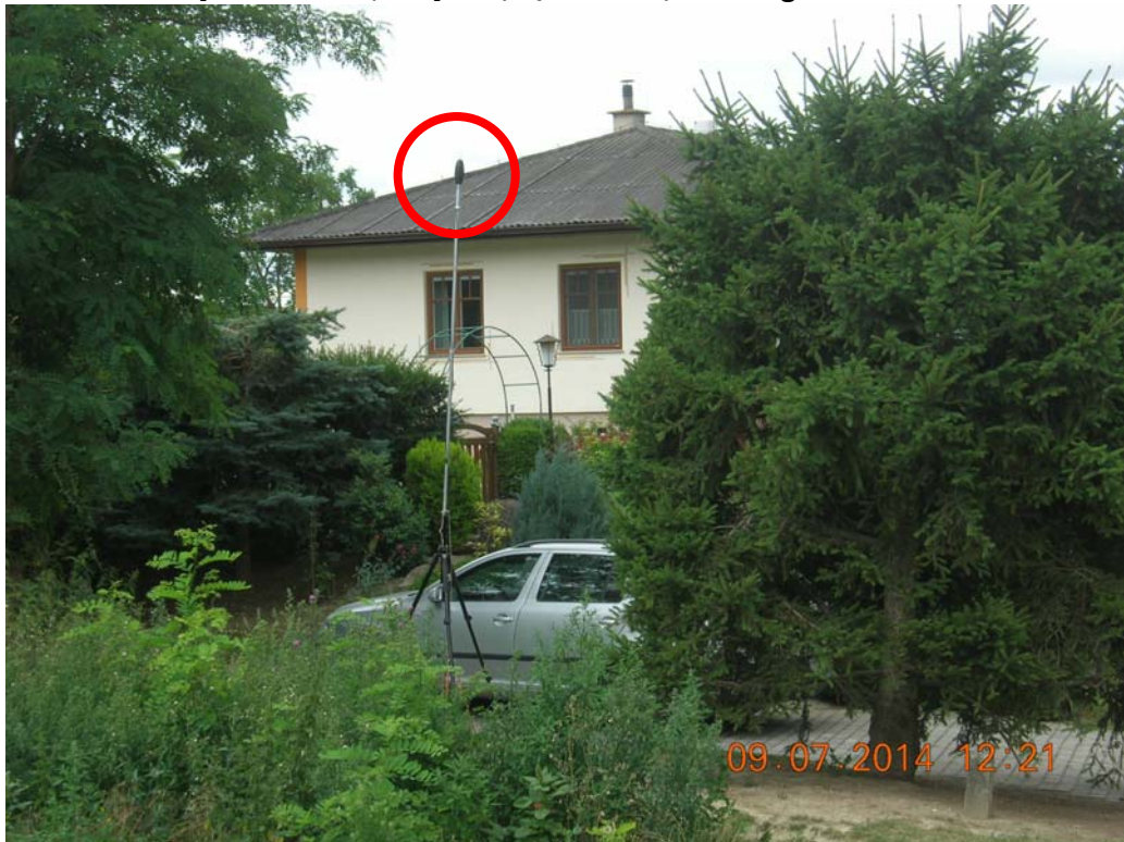
Abb. 19: Meßpunkt MP 10 – KG.Oberschoderlee; Meßzeitraum 09 – 10.07.2014; Koordinaten: [GK.M34 Rw/Hw] 574,4 / 390074,6 Meßgerät: Station 3 B&K 2236
