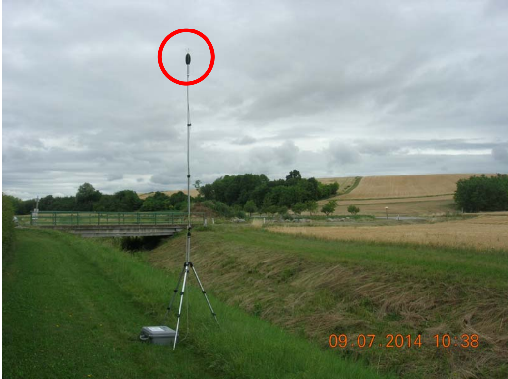
Abb. 11: Meßpunkt MP 06 – KG.Gnadendorf; Meßzeitraum 09 – 11.07.2014; Koordinaten: [GK.M34 Rw/Hw] 4477,9 / 386764,2 Meßgerät: Station R02 B&K 2238
