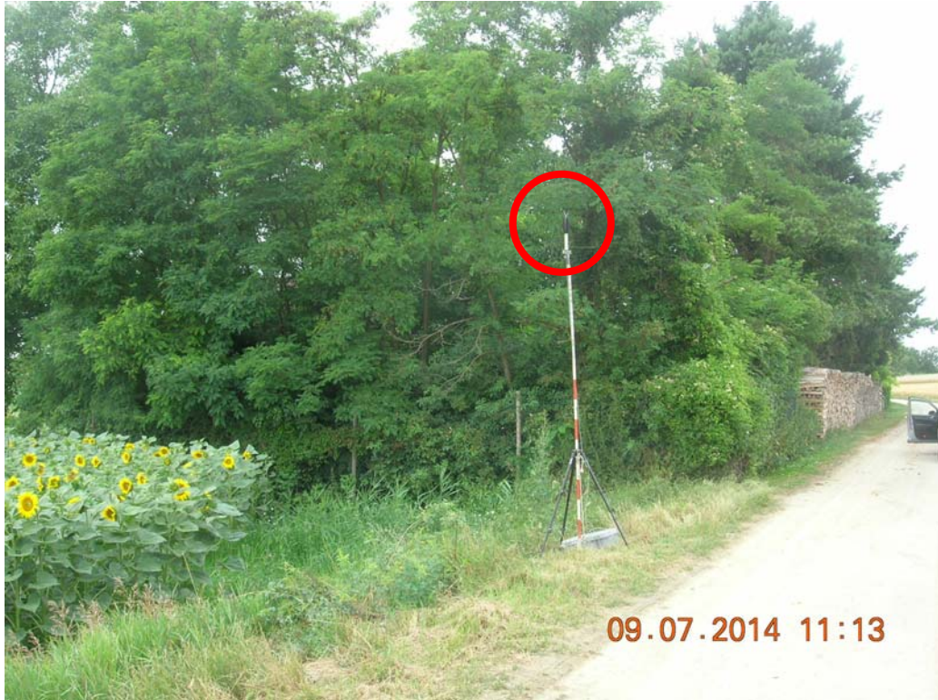
Abb. 13: Meßpunkt MP 07 – KG.Eichenbrunn; Meßzeitraum 09 – 10.07.2014; Koordinaten: [GK.M34 Rw/Hw] 2956,7 / 387008 Meßgerät: Station R01 B&K 2238
