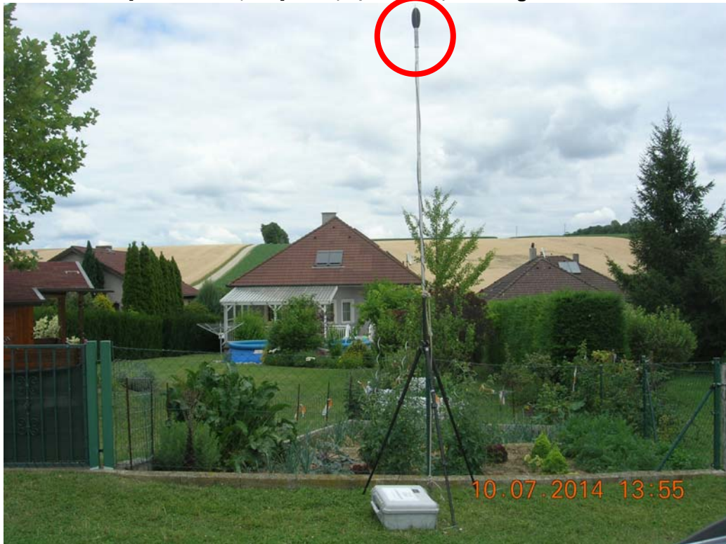
Abb. 7: Meßpunkt MP 04 – KG.Friebritz; Meßzeitraum 10 – 11.07.2014; Koordinaten: [GK.M34 Rw/Hw] 7054,3 / 388462,7 Meßgerät: Station 1 B&K 2236
