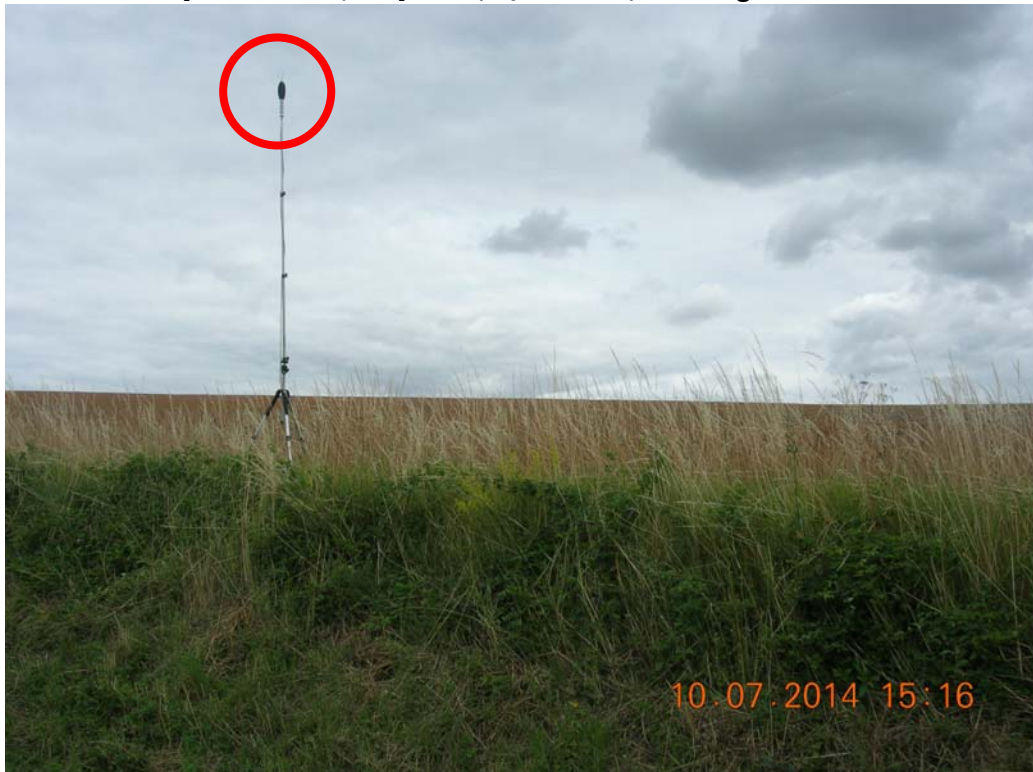
Abb. 3: Meßpunkt MP 02 – KG.Gaubitsch; Meßzeitraum 10 – 11.07.2014; Koordinaten: [GK.M34 Rw/Hw] 4693,9 / 388993,6 Meßgerät: B&K 2250
